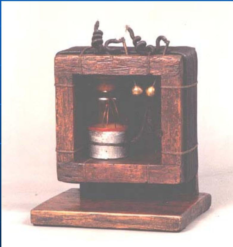
**Brevetto 7777**-Circuito sintonico oscillatore ad induttanza e capacità' - Londra 1898.
